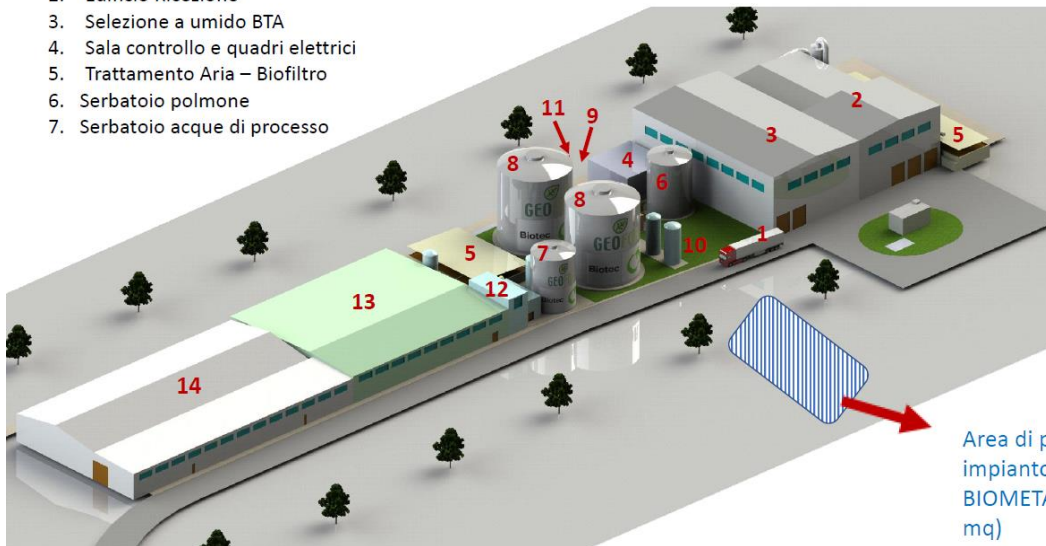
Rendering impianto di biodigestione anaerobica
