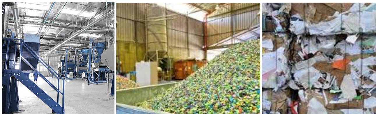
Figura 117- Ri-fabbrica dei materiali: piattaforma di pre-pulitura e preparazione al riciclo delle frazioni secche da RD.
